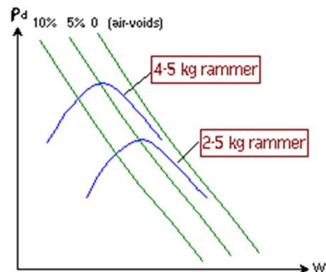
[Laboratory compaction tests](#)
